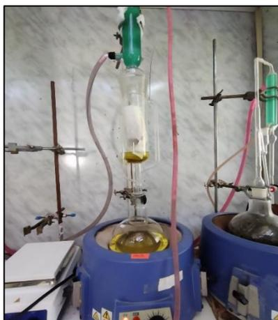
**Figure 8 :** Extraction par Soxhlet
