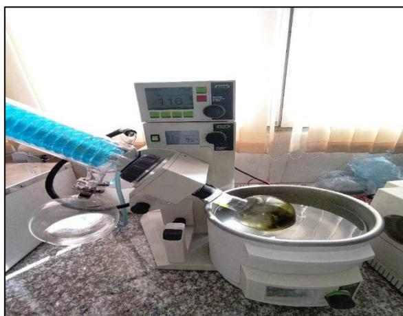
**Figure 9 :** Évaporation par le Rotavapor
